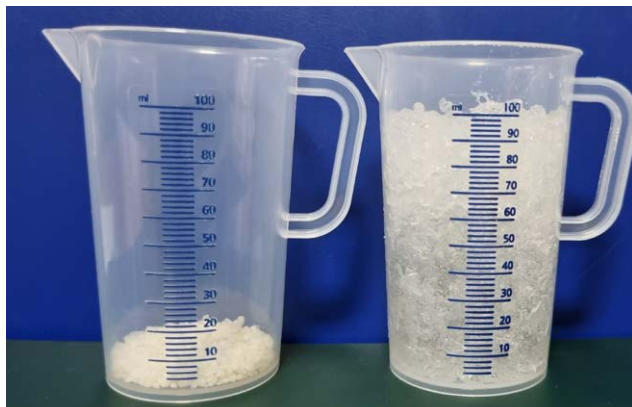
Fot. 7. Jeden gram prezentowanego hydrożelu pochłoniął 80 gramów wody wodociągowej (W. Treder)
