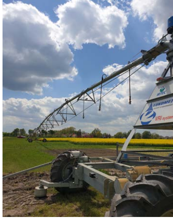
Fot. 46 Niskociśnieniowa deszczownia mostowa (W. Treder)
