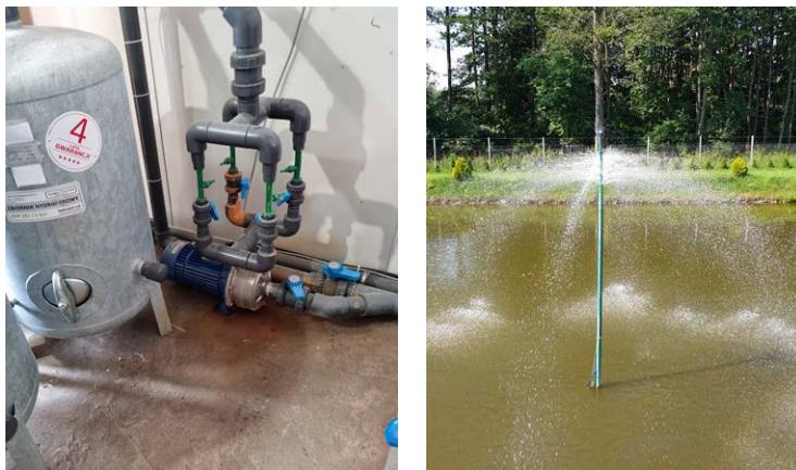
Fot. 34. Przykłady napowietrzanie wody za pomocą inżektorów i zraszania (W. Treder)
